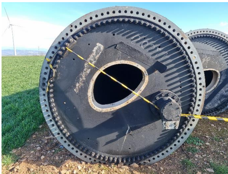
Figura 3. Vista lateral y unión con el buje de las palas de un aerogenerador.
