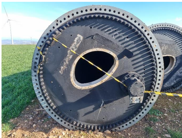
Figura 3: vista lateral y unión con el buje de las palas de un aerogenerador.
