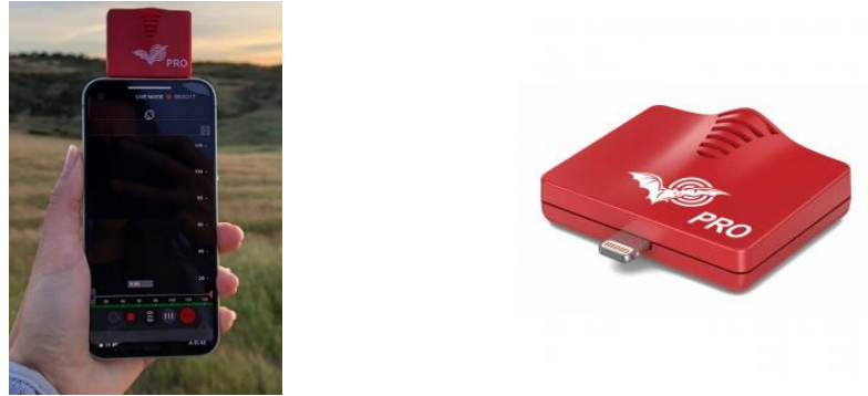
Figura 5. Detalle del dispositivo Echo Meter Touch insertado en un smartphone con la aplicación de utilización específica. Fuente: https://www.wildlifeacoustics.com
