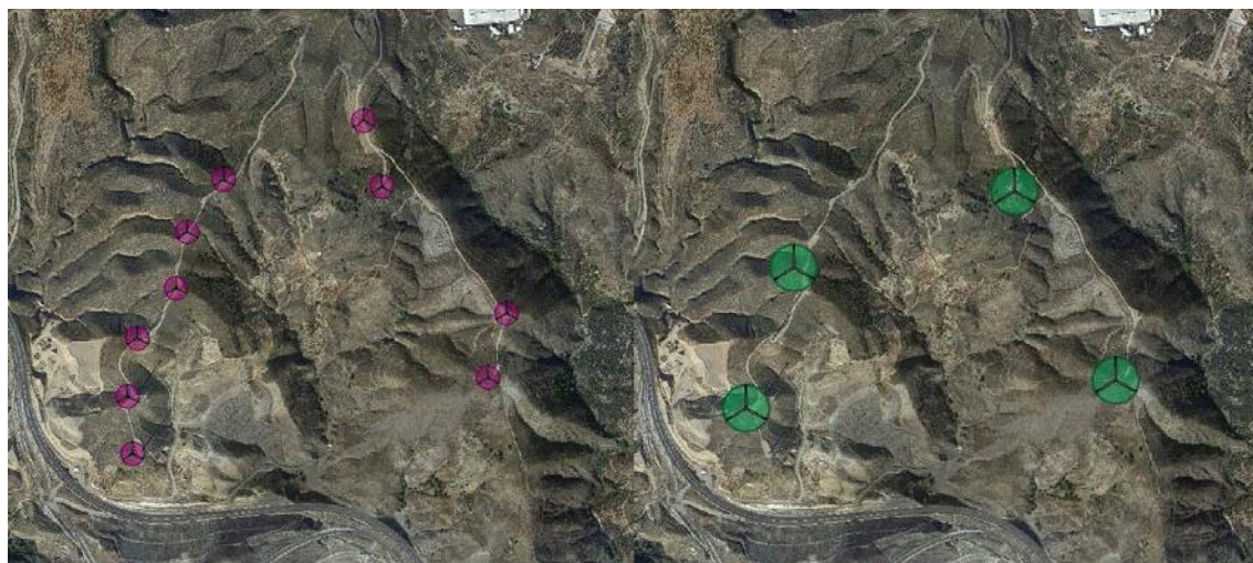
Figura 2. Izquierda aerogeneradores parque eólico Las Lomas actual y derecha repotenciado.
